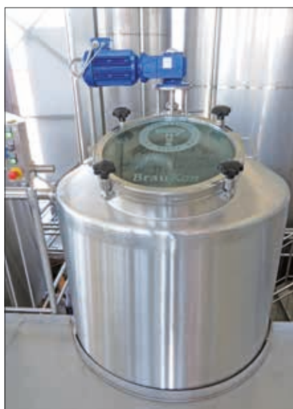
Solución de Late-Hopping-High-Efficiency para 120 kg de conos de lúpulo con descarga automatizada.
