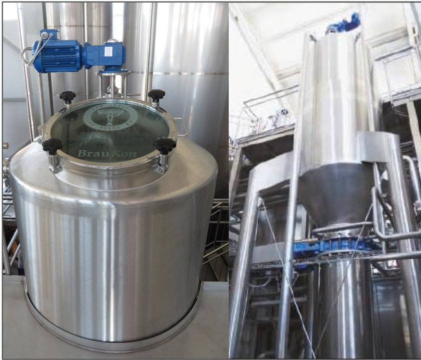
„Late-Hopping-High-Efficiency“-Lösung für 120 Kilogramm Dolden mit automatisierter Austragung
