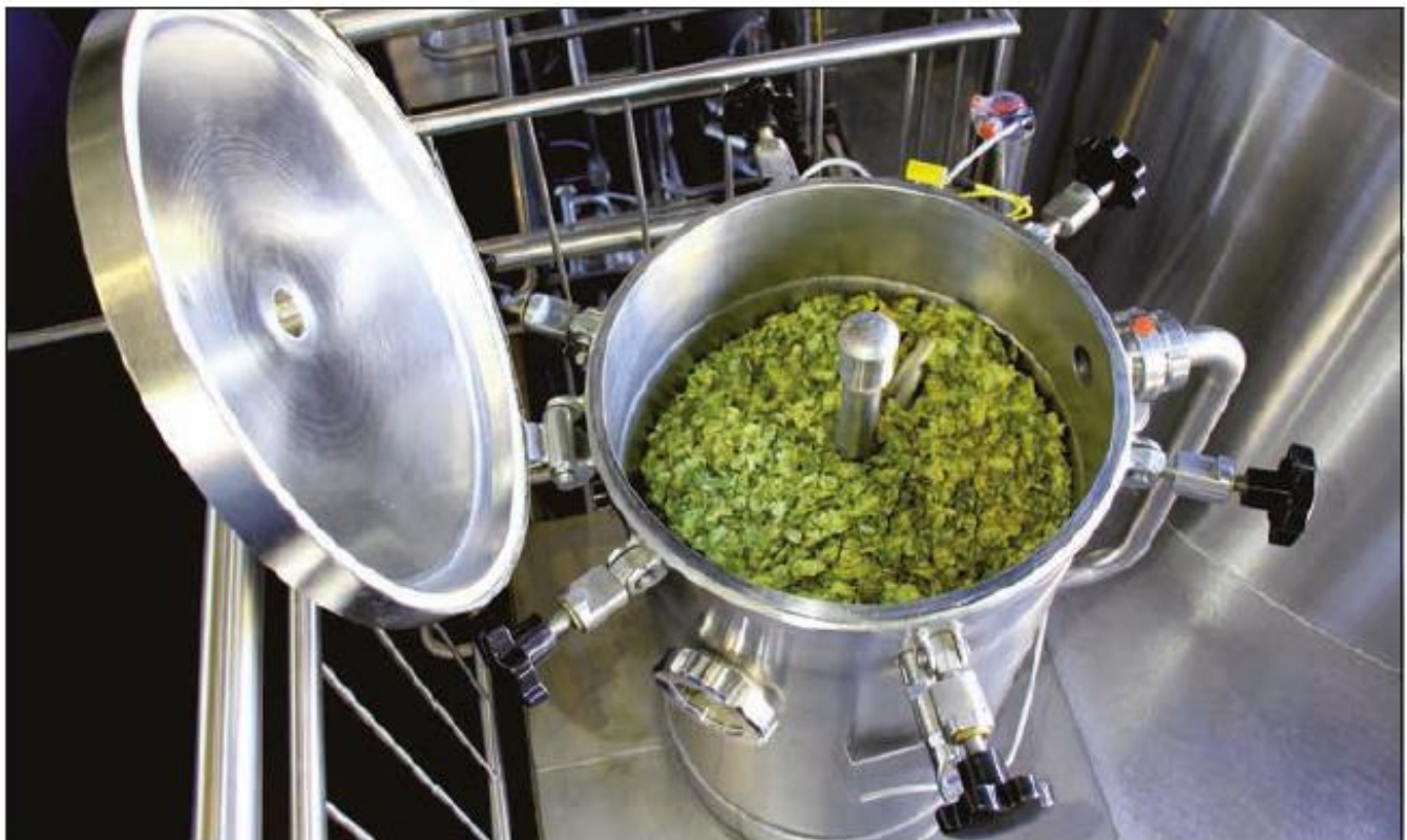
Die effiziente Auslaugung der Hopfenpellets mit einer optimierten Strömungsführung durch die Doldenschwimmschicht ist beim Late Hopping von großer Bedeutung.
