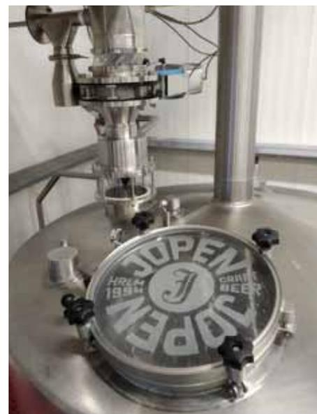
**Fig. 5** El nuevo premacerador integrado, junto con el nuevo agitador, necesita poca energía y proporciona templeas homogéneas
