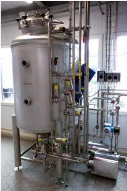
**Fig. 2** El dispositivo HopGun Pro integrado en un bucle de lupulación en frío garantiza un proceso automatizado de lupulación en frío
