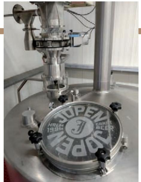
**Илл. 5 Встроенный новый предзаторник вместе с новой мешалкой обеспечивает равномерное затирание при низких энергозатратах**
