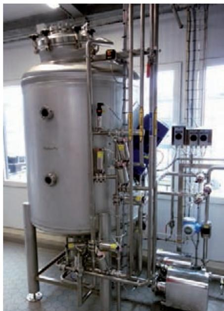
**Илл. 2** Контур Dry Hopping Loop, встроенный в систему HopGun Pro, обеспечивает ведение автоматизированного процесса холодного охмеления
