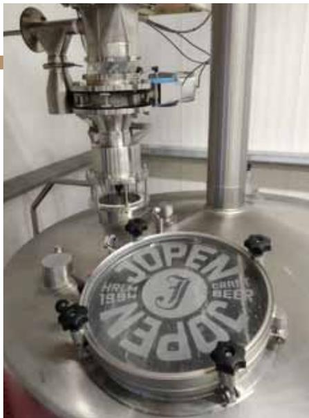
**Abb. 5 Der neu integrierte Vormaischer sorgt zusammen mit dem neuen Rührwerk energiesparend für homogene Maischen**
