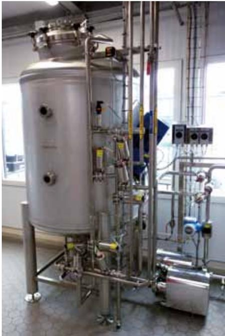
**Abb. 2** Die in einen Dry Hopping Loop integrierte HopGun Pro sorgt für einen automatisierbaren Kalthopfungprozess
